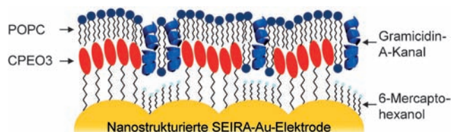
Abbildung 1. Schematische Darstellung der tBLM mit inkorporiertem Gramicidin A (gA) auf einer nanostrukturierten Goldelektrode. Die tBLM besteht aus einer 1-Palmitoyl-2-oleoyl-sn-glycero-3-phosphocholin (POPC)-Schicht auf einer Monolage aus (Cholesteryl)polyethylenoxythiol (CPEO3) und 6-Mercaptohexanol (6MH).
